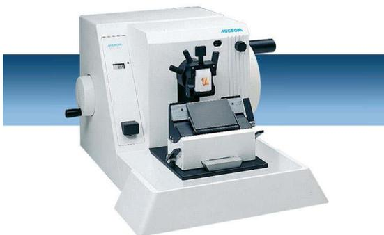
Рис. 4. Автоматический ротационный микротом HM 315 R
